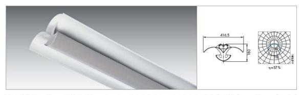
Sekundär-Reflektorleuchte aus Stahlblech, Zinkor weiß thermolackiert. Reflektorhalbschale aus mitroperforiertem Stahlbech, weiß thermolackiert, mit innenliegendem Lichtdiffuser. Für den Lampentausch muss die Lampenabdeckung nicht abgenommen werden. Auch als Lichtbandmontage möglich. Der Reflektor ist symmetrisch strahlend mit zusätzlicher Deckenaufhellung.
